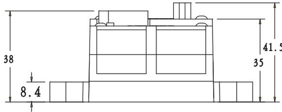
适用范围：用于汽车音响及其它低电压大电流用电设备的电流过载保护。
