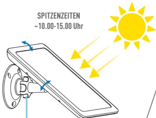
Sicherstellen, dass die Sicherungsmutter nach dem Einstellen der Neigung festgezogen ist
