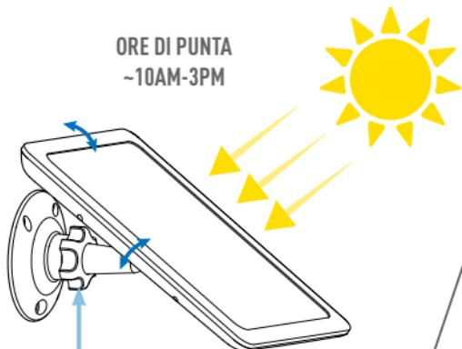
Assicurarsi che il dado di bloccaggio sia serrato dopo la regolazione dell'inclinazione
